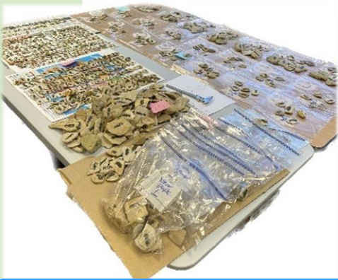
Cailloux équipés prêts à être disposés méthodologiquement sur les bancs de grève
