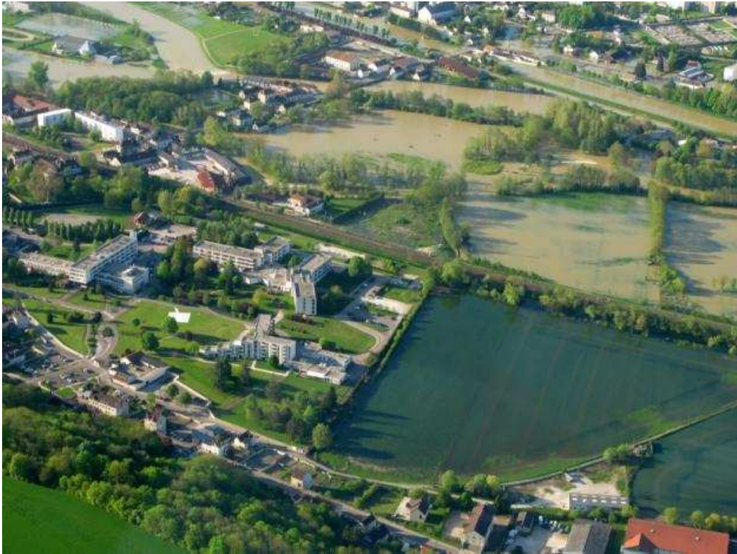
Photo 7 : inondation de mai 2013 à Tonnerre – inondation par remontée de nappe au-delà du remblai des voies SNCF
